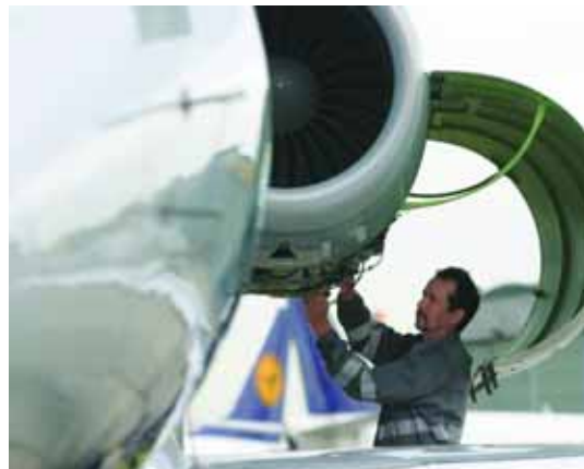
Lufthansa Bombardier Aviation Services GmbH (LBAS)-Mitarbeiter bei der Wartung des Triebwerks eines Bombardier Learjets
