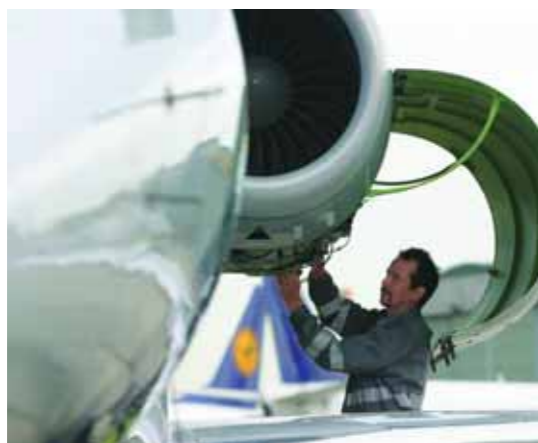
Des collaborateurs de la société Lufthansa Bombardier Aviation Services GmbH (LBAS) lors des travaux de maintenance du réacteur d'un bombardier Learjet.
